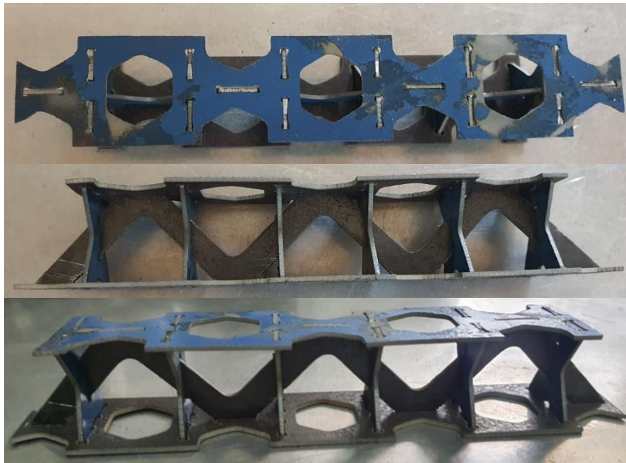
Fig. 18. Componentele grinzii asamblate temporar după fabricare
